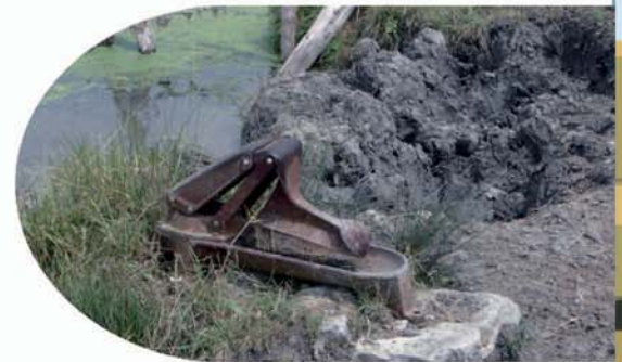
Installation d'une pompe de prairie en bordure de mare. © F. Macé
